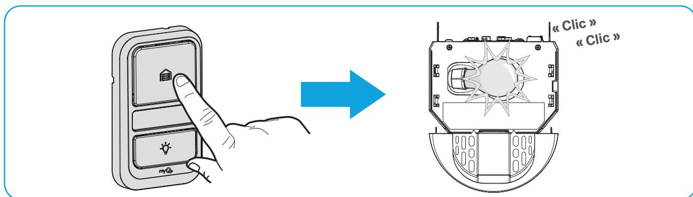
**EFFECTUEZ UN TEST :** Appuyez sur la barre de commande du panneau de commande. L'ouvre-porte de garage est activé. Si la porte de garage ne s'est pas activée, répétez les étapes de programmation.
