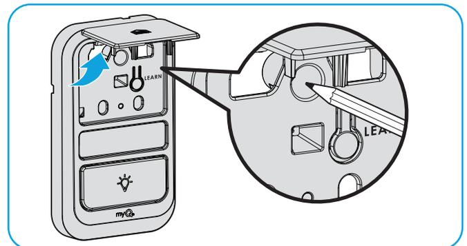
**05** Retirez le panneau de commande du mur et percez un trou de 5/32 po (4 mm) pour la vis du haut. Tapez dans l'ancrage à l'aide d'un marteau si vous l'installez sur une cloison sèche.
